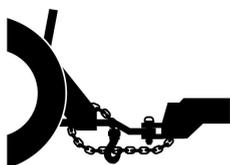
Ao acoplar o equipamento ao trator, utilize uma corrente para travar o cabeçalho do equipamento à barra de engate do trator. Esta medida evitará que as mangueiras hidráulicas venham a se romper ou que o equipamento venha a empinar em caso de quebra do sistema de engate.
